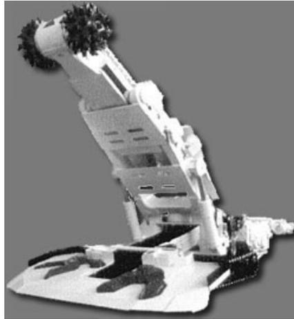
Рис. 27 Общий вид проходческого комбайна П220
