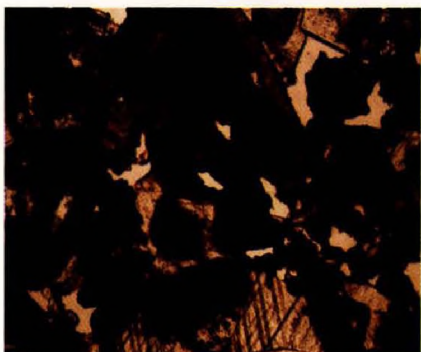
Рис. 36. Темно-коричневый битум пигментирует кальцит органических остатков. Отмечается в виде примазок на стенках пор и каверн в органогенно-детритовом известняке с базальным и поровым цементом кальцитового состава. Хорошо видны двойники в базальном кальцитовом цементе. Шлиф. Увел. 20 \times 10 , николь 1. Нижняя Пермь. Тимано-Печорская провинция
