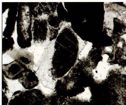
Рис. 32. Регенерационный кальцитовый цемент вокруг члеников криноидей в органогенно-водорослевом известняке. Шлиф. Увел. 5 \times 10 , николь 1. Нижняя Пермь. Тимано-Печорская провинция
