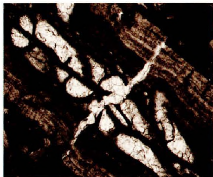
Рис. 30. Минеральная трещина, выполненная мелкозернистым кальцитом, сечет обломок мшанки в органогенном известняке. Шлиф. Увел. 5 \times 10 , николь 1. Нижняя Пермь. Тимано-Печорская провинция
