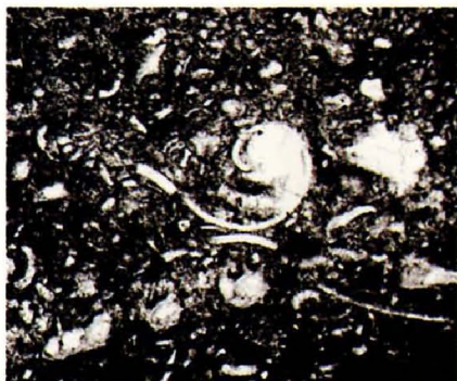
Рис. 34. Гастропода в органогенно-детритовом, сцементированном тонкозернистым кальцитом известняке. Тип цемента базальный. Шлиф. Увел. 5 \times 10 , николь 1. Нижняя Пермь. Тимано-Печорская провинция
