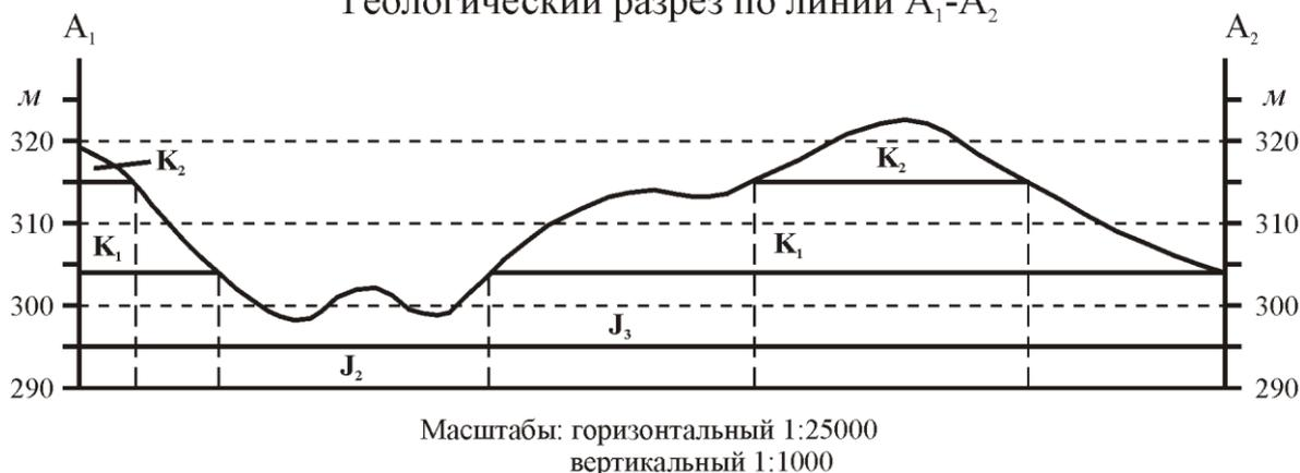
Рис. 3.4. Разрез участка с горизонтальным залеганием слоев
