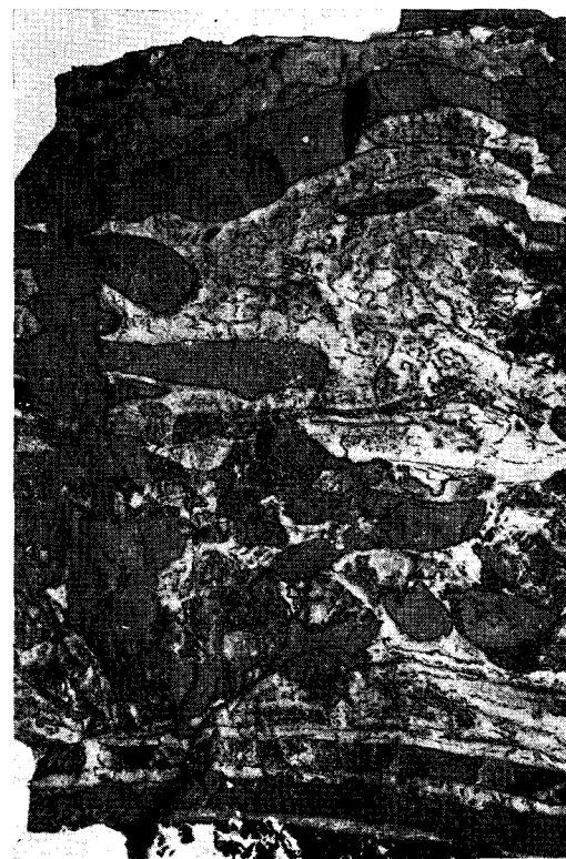
Рис. 80. Замещение полосчатого железистого кварцита (светло-серое) дисперсным гематитом (неправильные извилистые темно-серые участки). Месторождение им. Кирова. Из колл. Г. В. Тахтуева. Натур. вел.
