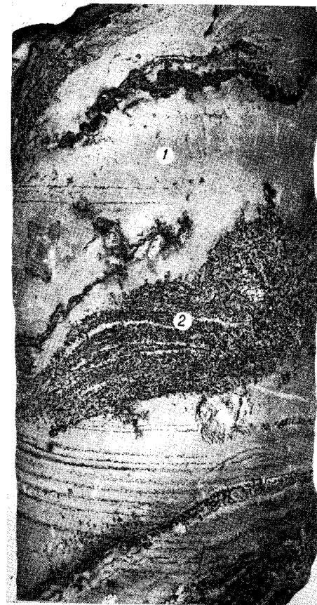
Рис. 13. Керн тальковых сланцев — 1, с прослоями песчаников — 2; \frac{3}{4} натур. вел.
