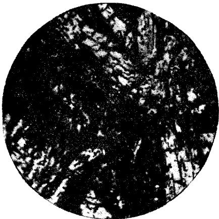
Рис. 81. Псевдоморфозы супергенного кварца (светлое) по кумминггиту. Без анализатора, \times 30 .
