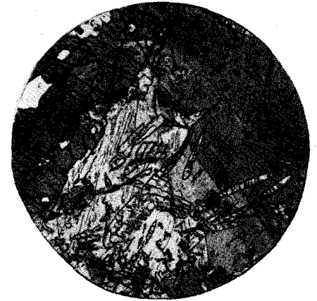
Рис. 43. Плагиоклазово-биотито-антофиллитовые породы с турмалином из месторождения «Камчатка». Без анализатора, \times 15 .
