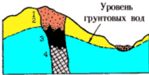
Рис. 76. Схема зоны окисления рудных месторождений.
