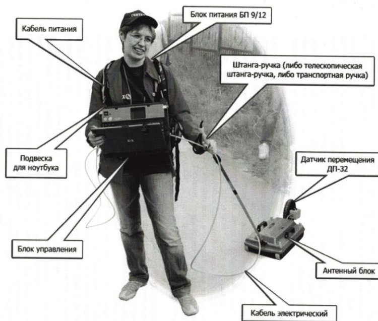
Рисунок 4.12 – Георадар в походном положении.
