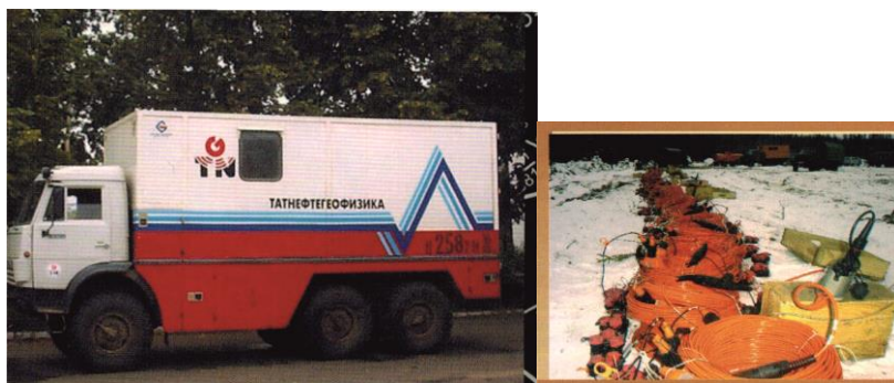
Рисунок 4.11 – Электроразведочная станция на автомобиле высокой проходимости. Рядом бухты проводов для производства зондирований.
