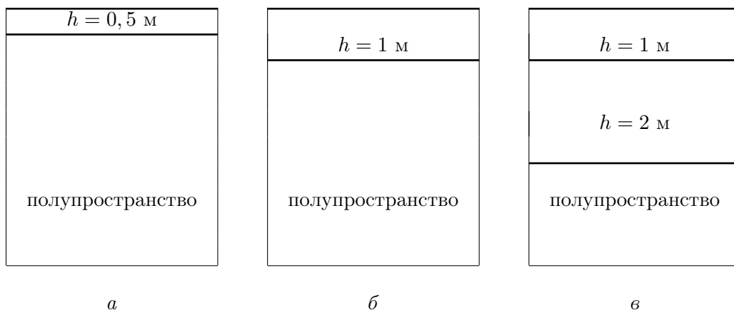
Рис. 4.1. Модели двухслойного ( а, б ) и трехслойного ( в ) полупространств. Результаты расчета амплитудно-частотных характеристик штампа, расположенного на поверхности слоистого полупространства приведены на рис. 4.2–4.4 соответственно
