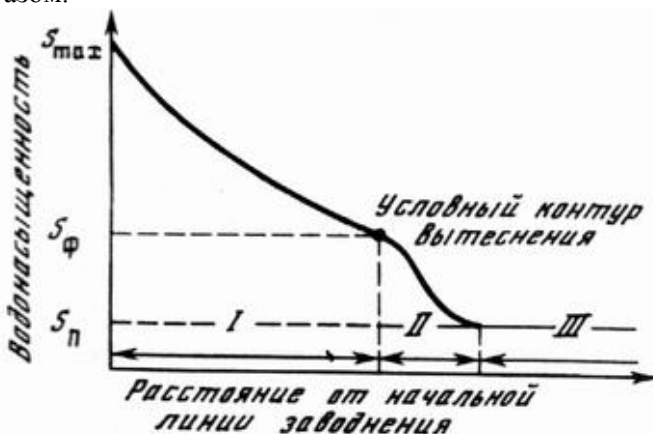
Рис. 8.2. Изменение нефтewedонасыщенности по длине пласта при вытеснении нефти водой
