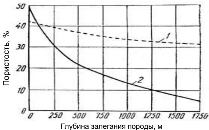
Рис. 1.3. Влияние естественного уплотнения пород на их пористость: 1 – песчаники, 2 – глины
