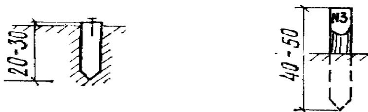
Рис. 21. Закрепление точек линии гвоздями и кольями
