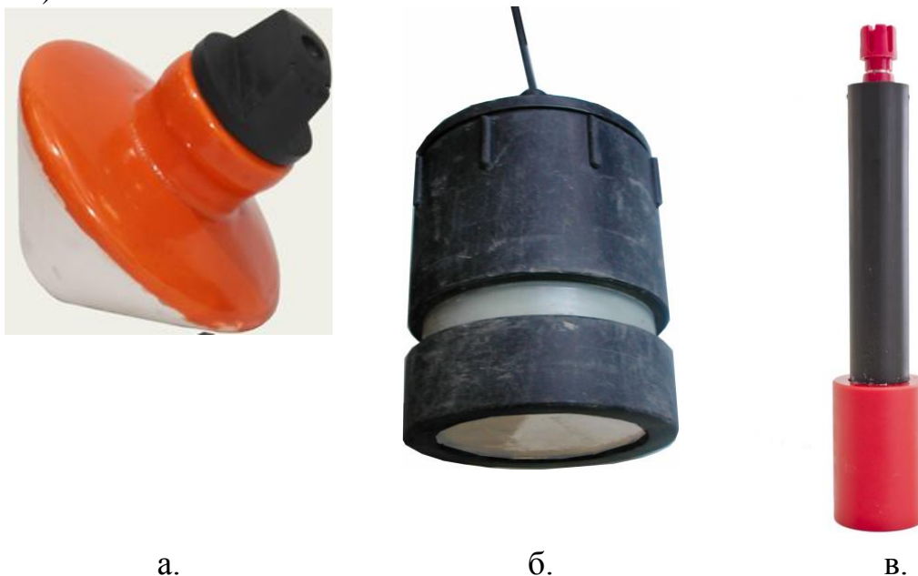
Рис. 3.1.4. Неполяризующиеся электроды а. – меднокадмиевый электрод, б. – меднокадмиевый гелевый электрод, в. – свинцовохлоридный электрод.
