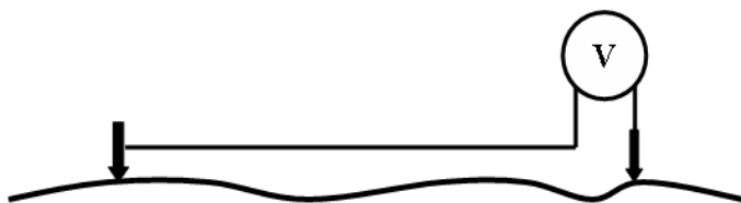
Рис. 3.1.2. Электроразведочная установка для измерения естественного электрического поля
