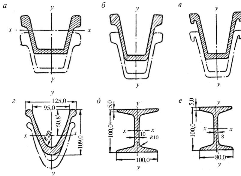
Рис.10. Специальный стальной прокат для горной крепи: *a* – спецпрофиль СП (подтипы А и Б); *б* и *в* – спецпрофиль взаимозаменяемый с желобчатыми фланцами (СВПЖ); *г* – взаимозаменяемый V-образный спецпрофиль; *д* и *е* – широкополочный двутавр 100 × 100 и 100 × 80 мм соответственно
