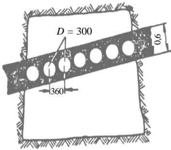
Рис.33. Схема выемки угля в забое штрека путем бурения скважин
