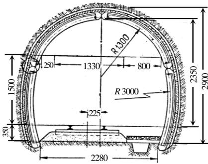
Рис. 16. Железобетонная арочная шарнирная крепь
