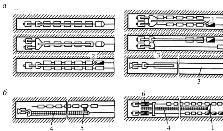
Рис.24. Схемы транспортирования горной массы в призабойной зоне с применением перегружателя (а) и конвейера (б):
