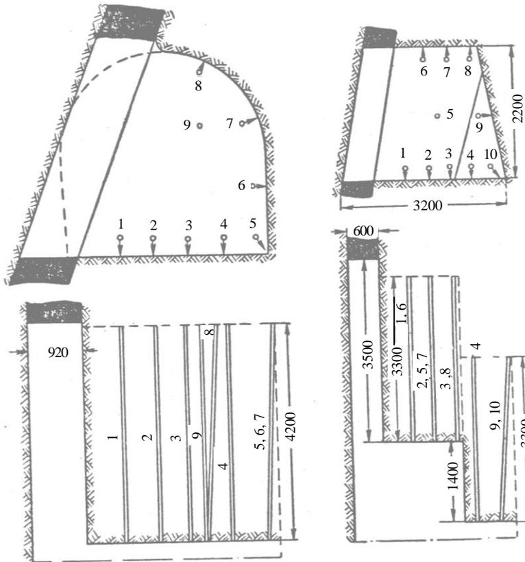
Рис.34. Схемы расположения шпуров в породном забое при проведении штрека по крутому пласту
