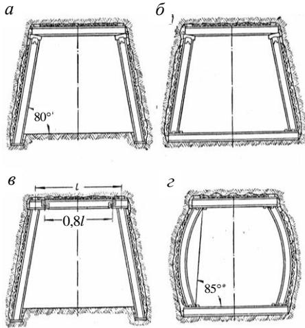
Рис.11. Металлические рамы
