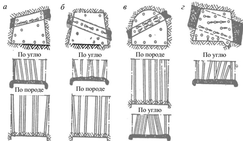
Рис.32. Схемы расположения шпуров при тонком пласте
