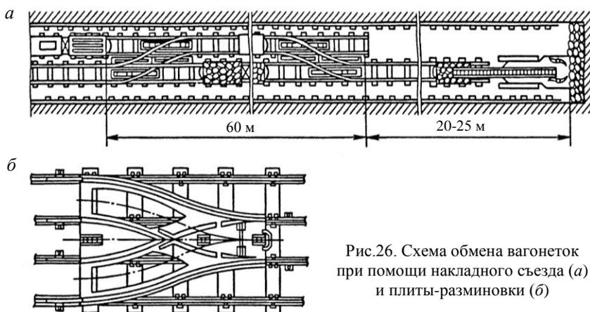
Рис.26. Схема обмена вагонеток при помощи накладного съезда (а) и плиты-разминовки (б)
