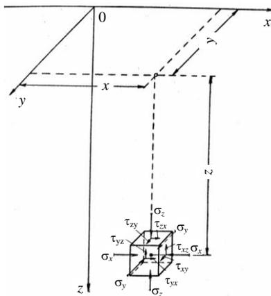
Рис.7. Схема к определению напряженного состояния массива горных пород
