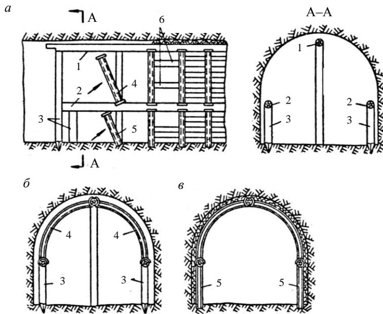
Рис.28. Последовательность операций при возведении металлической арочной шарнирной крепи
