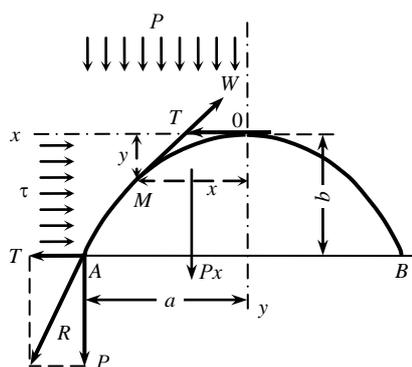
Рис.9. Расчетная схема определения горного давления на кровлю горизонтальной выработки по гипотезе Протоdjяконова
