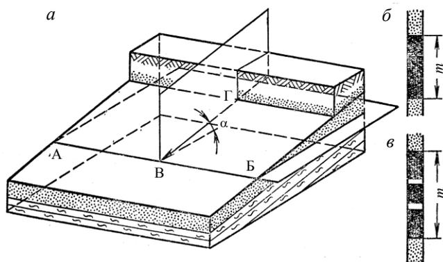
Рис.1. Элементы залегания пласта
