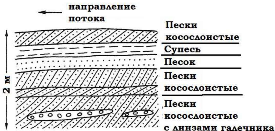
Рис. 4. Типичный разрез флювиогляциальных зандровых отложений
