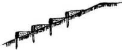
Рис. 2. Укрепление откосов плетневыми заборами
