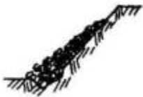
Рис. 5. Укрепление откоса каменной наброской
