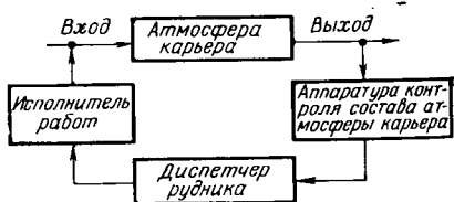
Рис. 6.10. Функциональная структура автоматизированной системы управления вентиляцией
