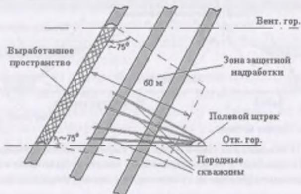
Рис. 14.7. Схема дегазации пластов после надработки породными скважинами с полевого штрека
