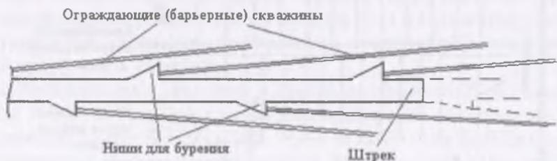
Рис. 14.8. Схема проходки подготовительной выработки с бурением ограждающих (барьерных) скважин
