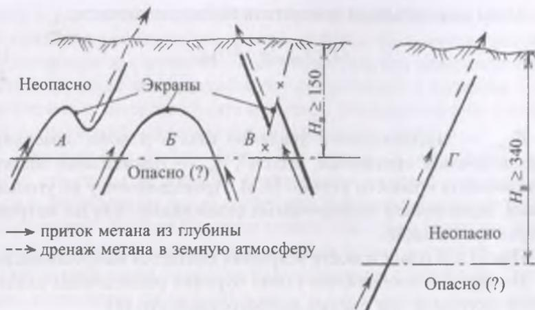
**Рис. 4.5. Прогноз выбросоопасной глубины разработки пластов  $H_g$  по геологическим разрезам:**
