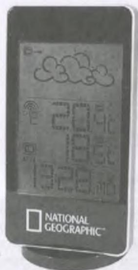
*Рис. 15.11. Электронный барометр для измерения давления в горных выработках*
