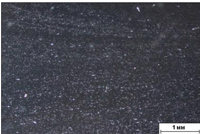
Рис. 34. Вулканическое стекло. Структура стекловатая (гиалиновая). В стекле (черное поле) отмечаются субмикроскопические мерцающие точки, которые представляют собой зародыши минералов. Николи X
