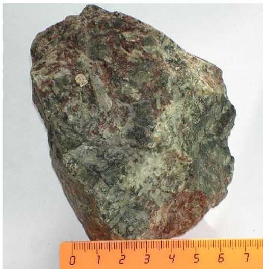
Рис. 50. Нефелиновый сиенит (хибинит) с однородной (массивной) текстурой. Порода сложена, главным образом, калишпатом и нефелином (светлые минералы), при подчиненной роли эгирина (зеленый) и эвдиалита (бардовый)
