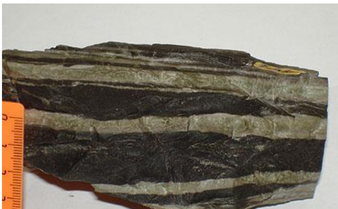
Рис. 99. Роговик с реликтовой полосчатой текстурой, обусловленной чередованием светлых и темных полос
