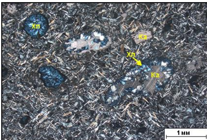
Рис. 59. Метабазальт с миндалекаменной текстурой. В породе наблюдаются округлые миндалины, сложенные хлоритом (Хл) и кальцитом (Са). Нередко миндалины имеют зональное строение: их внутренняя часть выполнена кальцитом, а внешняя кайма – хлоритом. Основная масса породы имеет интерсертальную структуру и состоит из многочисленных хаотично расположенных микролитов плагиоклаза, интенсивно соссорицизированного. Николи X
