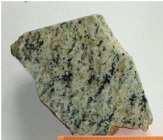
Рис. 53. Нефелиновый сиенит (мариуполит) с выраженной гнейсовидной текстурой, обусловленной субпараллельным расположением чешуйчатых индивидов и цепочечных агрегатов слюды (лепидомелана). Основная масса породы сложена светло-бурым нефелином и белым альбитом
