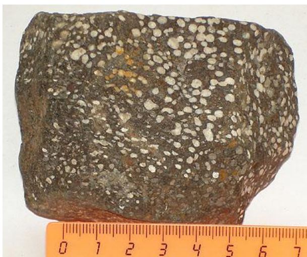
Рис. 57. Базальт с пористой, миндалекаменной текстурой. Многочисленные округлые поры выполнены кальцитом, который выделяется белым цветом
