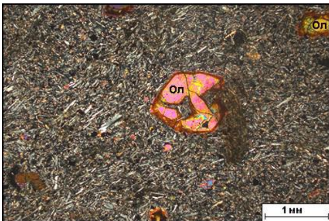
Рис. 44. Порфировый оливиновый базальт. Основная масса имеет интергранулярную структуру. Отличительным признаком которой является присутствие в интерстициях мелких субизометричных зерен оливина и клинопироксена. Порфировые вкрапленники представлены зернами оливина. Николи X
