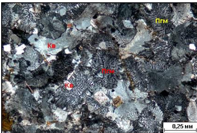
Рис. 38. Микрогранит с микропегматитовой структурой (Пгм), обусловленной закономерным срастанием кварца и калишпата, в породе отмечаются также зерна чистого кварца (Кв). Николи X
