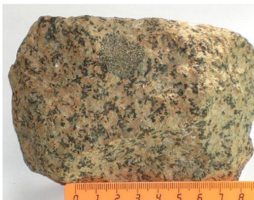
Рис. 51. Сиенит со шлировой текстурой. Порода сложена, преимущественно, калишпатом при подчиненной роли плагиоклаза и темноцветных минералов. Шлировые обособления выделяются более мелкозернистой структурой и обогащены темноцветными минералами
