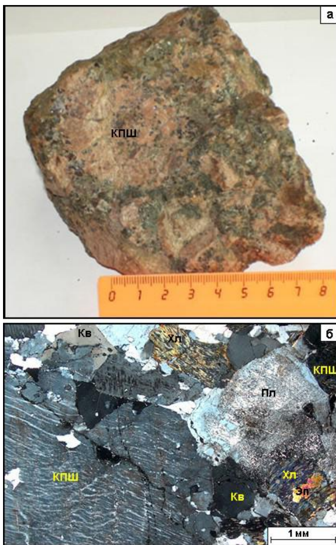
Рис. 7. Гранит с порфировидной структурой. Размер порфировидных вкрапленников до 4 см, они представлены калишпатом (КПШ). Основная масса мелкозернистая и сложена зернами от 1 до 2 мм калишпата (КПШ), плагиоклаза (Пл), кварца (Кв), псевдоморфозами хлорита по биотиту (Хл) и эпидотом (Эп): а) макросъемка; б) микросъемка, николи X
