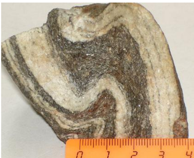
Рис. 100. Мигматит с пloyчатой текстурой, обусловленной наложенными пластическими деформациями, в результате которых полосы в породе были собраны в мелкие складочки
