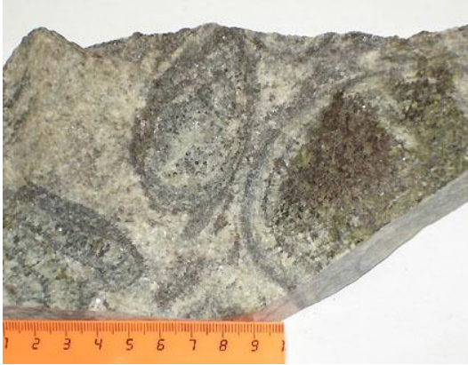
Рис. 61. Габбро с шаровой текстурой, обусловленной присутствием в породе эллипсоидальных концентрически-зональных образований среди кристаллически зернистой основной массы
