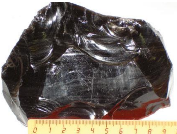
Рис. 56. Вулканическое стекло (обсидиан) с плотной (компактной) текстурой. Отличается характерным черным цветом и раковистым изломом
