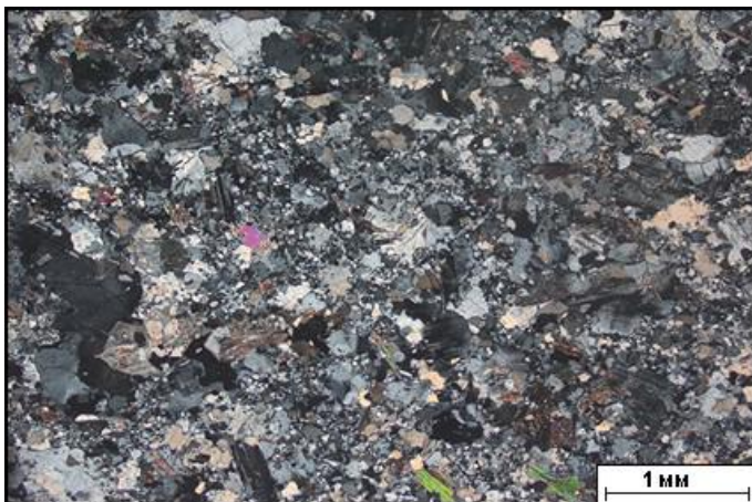
Рис. 14. Аплит представлен тонко-микрозернистым агрегатом минералов. Порода сложена зернами кварца (Кв), калишпата (КПШ), кислого плагиоклаза (Пл) и биотита (Би). Минералы имеют субизометричную и неправильную форму, обычно с изрезанными, заливообразными контурами, что определяет аплитовую структуру породы. Николи X
