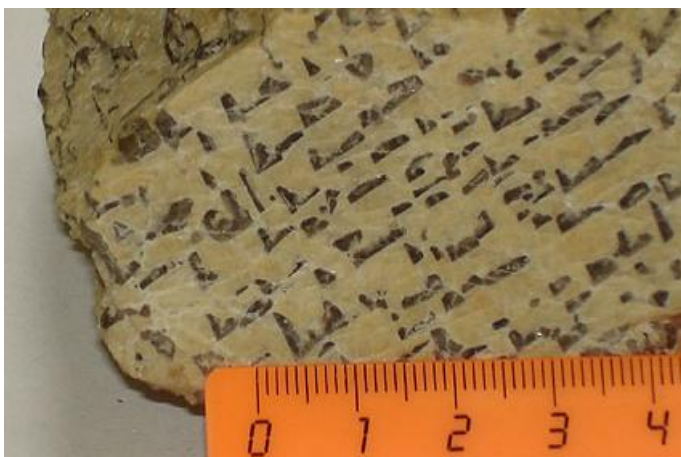
Рис. 29. Гранит-пегматит с письменной структурой, обусловленной наличием в зернах калишпата закономерных клинообразных включений кварца в виде специфического рисунка, напоминающих иероглифы
