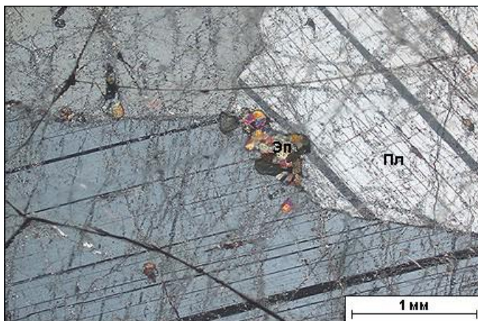
Рис. 2. Анортозит. Крупнозернистая структура. Порода состоит из крупных (5-9 мм) зерен плагиоклаза (Пл). Отмечаются единичные зерна эпидота (Эп), которые хорошо выделяются своей яркой интерференционной окраской. Николи X
