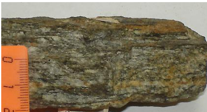
Рис. 94. Двуслюдяной кристаллический сланец со сланцеватой текстурой, обусловленной субпараллельным расположением минеральных агрегатов биотита, мусковита и кварца
