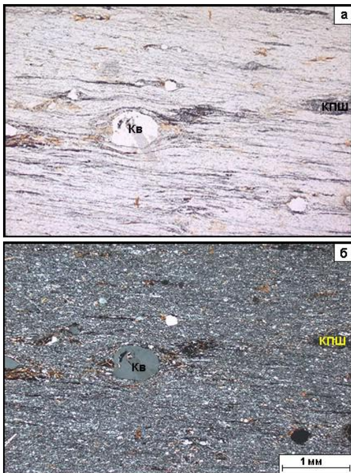
Рис. 91. Милонит с одноименной милонитовой структурой. Порода сложен тонкоперетертым материалом и обнаруживает отчетливую сланцеватую текстуру. В породе наблюдаются редкие порфирокластовые вкрапленники, имеющие округлую, линзовидную форму и ориентированные согласно сланцеватости: а) николи II, б) николи X
