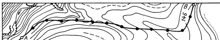
Рис. 78. Схема прокладки трассы с заданным уклоном
