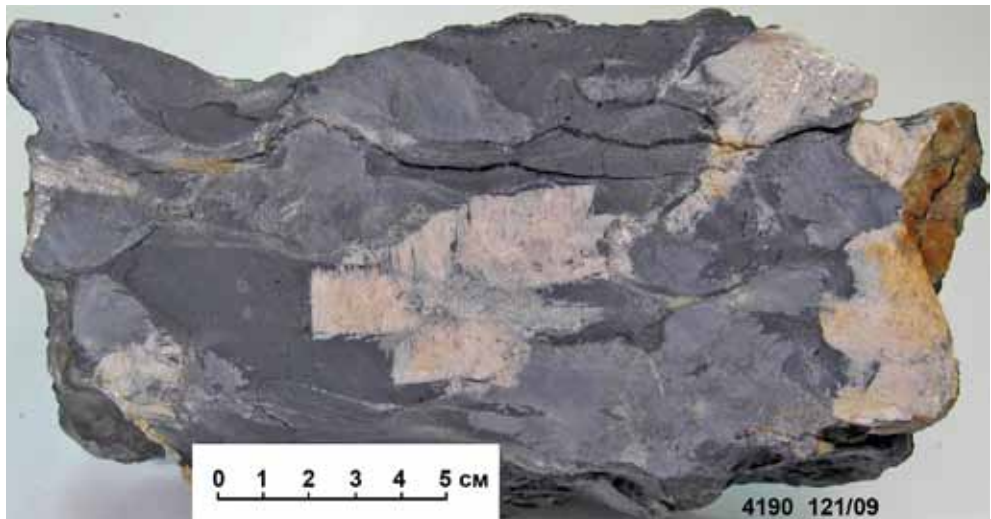
Рис. 2.1.49. Порфиробластовая текстура кианитового сланца с параморфическим (белое) и конкреционным (серое) кианитом в углеродистой кварцево-слюдистой массе (черное). Штуф, Новая Шуурурга. Колл. Нерадовского Ю.Н.
