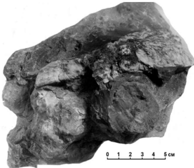
Рис. 2.1.45. Конкреционно-параморфическая текстура кианитовой руды. Видны округлые конкреции и бруски параморфоз кианита. Воргельурта [Бельков, 1958].
