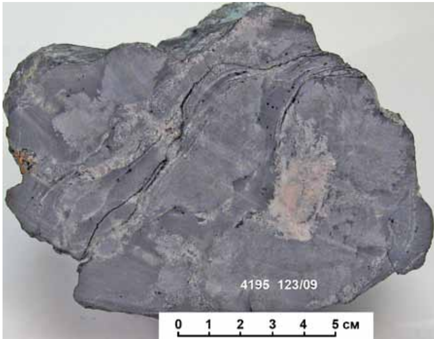
Рис. 2.1.48. Пятнистая текстура кианитового сланца с параморфическим (белое) и конкреционным (серое) кианитом в углеродистой кварцево-слюдистой массе (черное). Штуф, Новая Шуурурга. Колл. Нерадовского Ю.Н.
