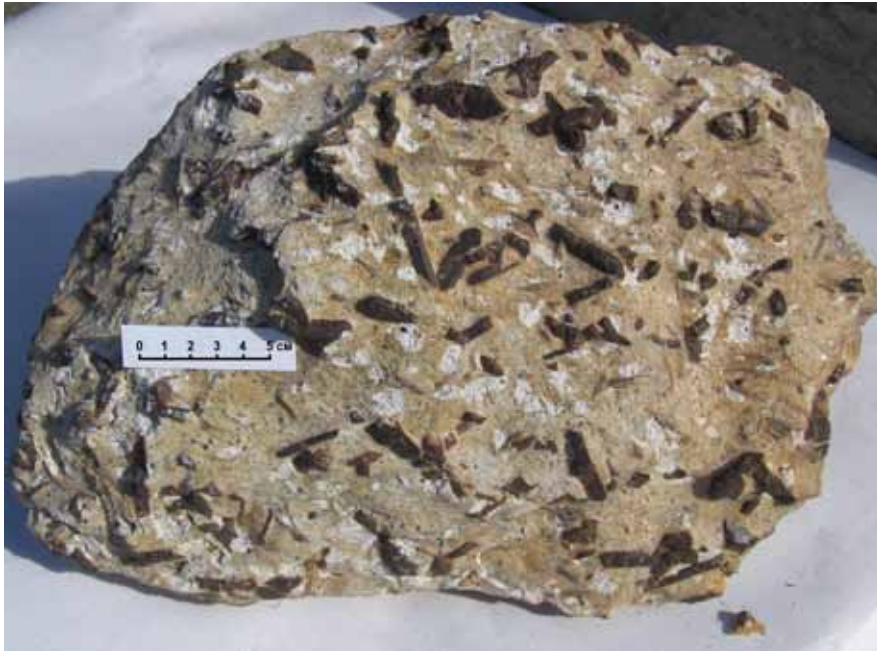
Рис. 2.2.1. Порфиробластовая текстура сланца с порфиробластами ставролита (темное) и плагиоклаза (белое) в тонкозернистой слюдяно-кварцевой основной массе. Штуф, выветрелая поверхность. Колл. Нерадовского Ю.Н.
