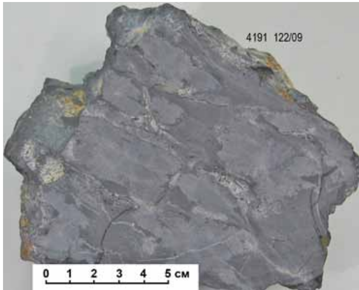
Рис. 2.1.34. Пятнистая текстура в разрезе мелкоконкреционной руды. Видны многочисленные неправильные удлиненные (светлые) пятна из тонковолокнистого кианита в темно-серой слюдяной массе. Штуф, Новая Шуурурта. Колл. Нерадовского Ю.Н.
